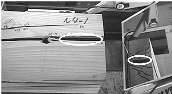
第6図 破壊の進行状況（最大荷重時）
