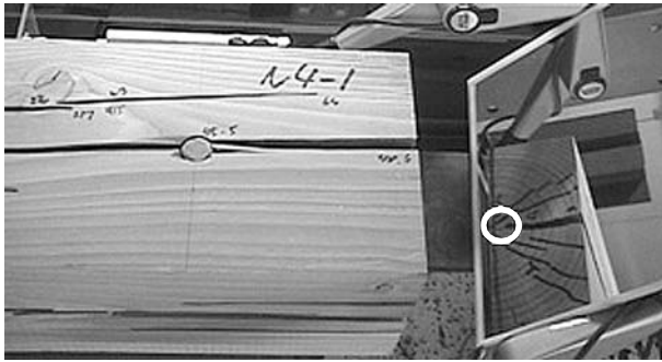
第5図 破壊の進行状況（割裂発生時）
