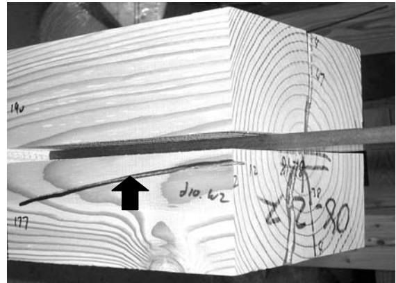
第2図 ドリフトピンに直交する割れ
