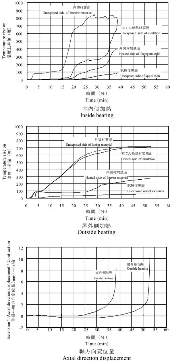
第4図 充てん断熱試験体の試験結果
