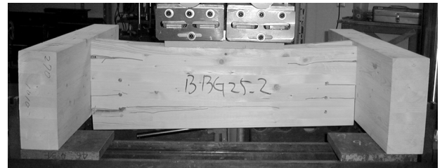
第12図 せん断試験の破壊形態（梁－梁，梁の割裂）
