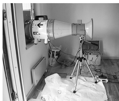
第3図 気密性能測定の様子 Fig. 3. Airtightness measuring system.
