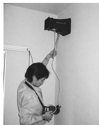
第4図 換気量測定時の様子 Fig. 4. The method used for the ventilation test.
