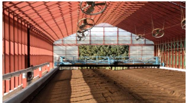
写真 3-1-3-1-8 温水床加温型乾燥施設
