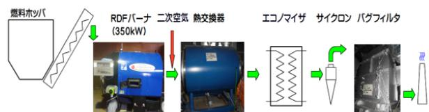
図 3-2-3 改良後の燃焼システムの機器構成燃
