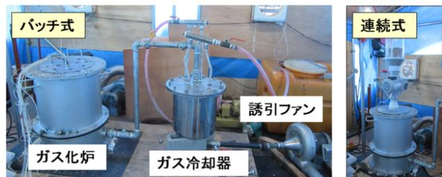
図 3-1-5-2 ガス化装置の外観
