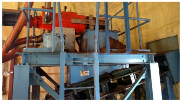
写真 3-1-3-1-7 固液分離機（プレス型圧搾機）
