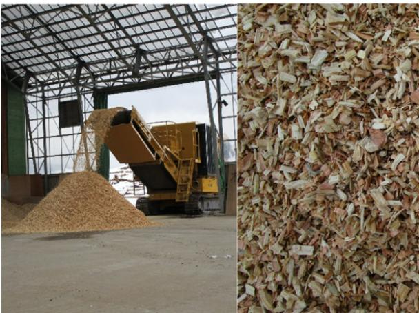
図 4-3-5 燃料用チップの製造(左)と製品(右)
