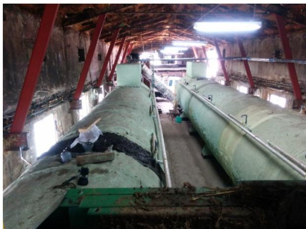
写真 3-1-3-1-10 円筒型発酵槽
