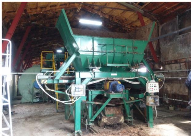
写真 3-1-3-1-9 原料受け入れ部（破砕機）
