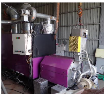
図4-2-6 燃焼試験に使用した小規模(80kW)ボイラ
