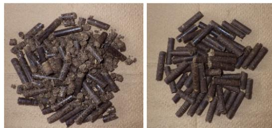
写真 3-1-3-2-2 原料水分 15%（左）及び 19%（右）での造粒状態
