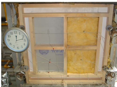
第 16 図 石膏ボードの加熱試験の様子 Fig. 16. Overview of fireproof test using gypsum board specimen.
