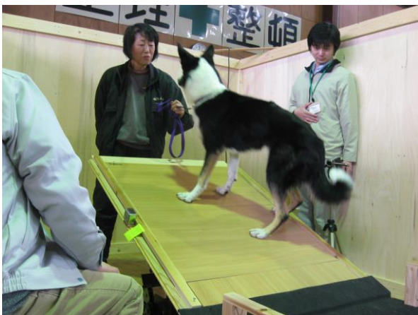
第 1 図 犬による傾斜法試験
