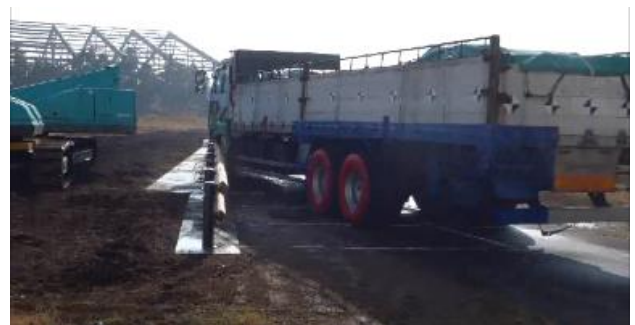
第 1 図 実車衝突試験による性能確認
