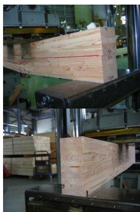
第 2 図 補修の有無と破壊形態 (上段：補修なし，下段：補修あり)
