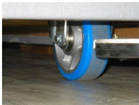
第 3 図 1 軸 1 輪構成
