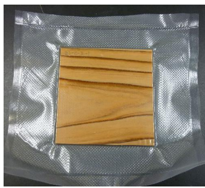
第 2 図 標準腐朽試験片 (スギ, 6 週間)
