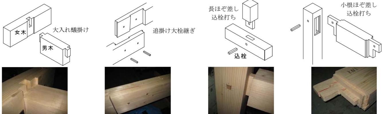
第 1 図 伝統的接合部の形状と試験終了後の様子
