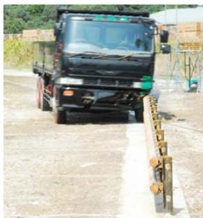
第 1 図 実車衝突試験の様子
