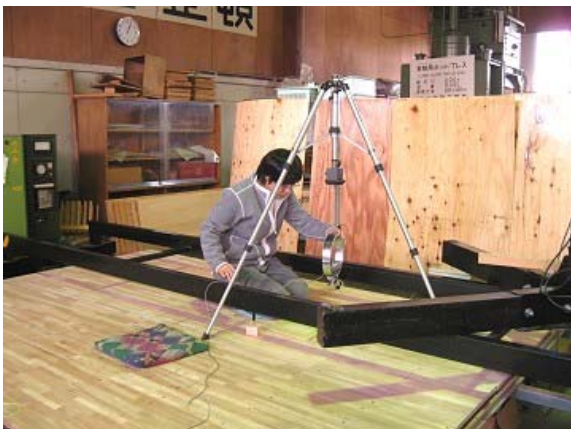
第 1 図 実大床における床性能測定
