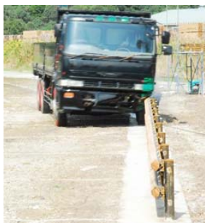
第 1 図 実車衝突試験の様子
