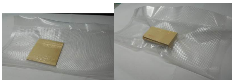
1 枚で密封 複数枚で密封 第 2 図 腐朽モデル試験体のラッピング
