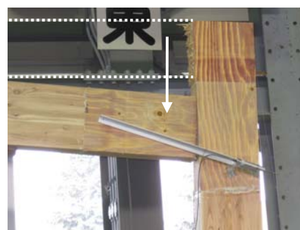
第 3 図 梁の付け根における曲げ破壊の模様
