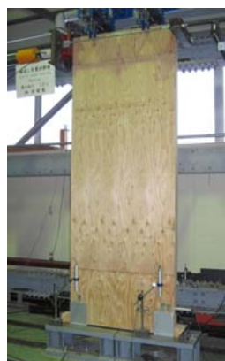
第 2 図 LVL 厚板壁の 面内せん断試験
