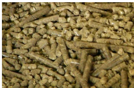
第 1 図 南幌町で製造された稲わらペレット燃料
