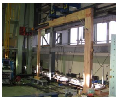
第 2 図 門形フレーム試験の模様
