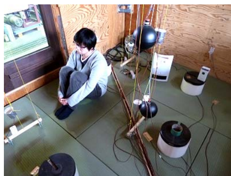
第 2 図 武道畳敷床での体感温度試験
