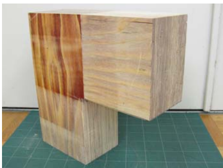
第 1 図 開発した単板積層圧密接合による L 字形コーナー要素
