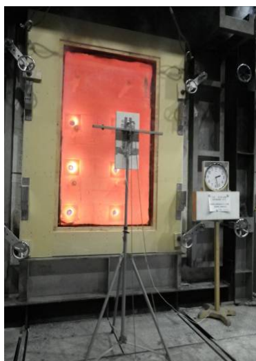
写真 耐熱強化 2 枚構成仕様 実大試験（26 分経過時）
