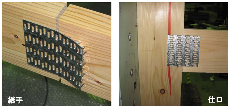
第 1 図 メタルプレートコネクタ接合部の破壊状況
