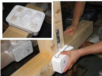
第 1 図 腐朽源ユニットと 腐朽処理の様相
