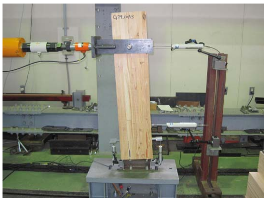
第1図 モーメント抵抗試験
