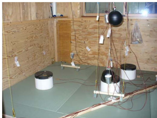
第 1 図 床暖房試験室内部の概要
