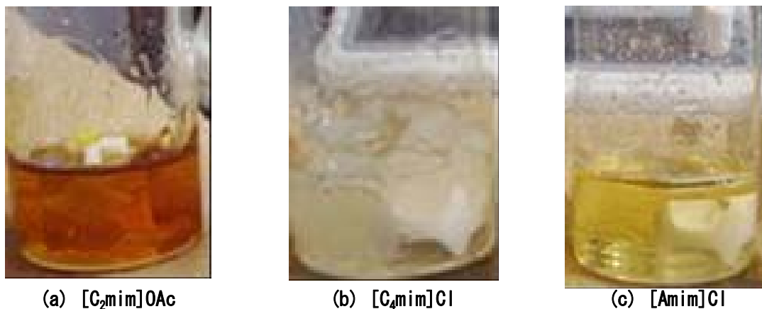
第 2 図 100°C におけるセルロース 10% (w/v) の溶解状況
