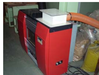
第 3 図 接続アタッチメントの取付状況
