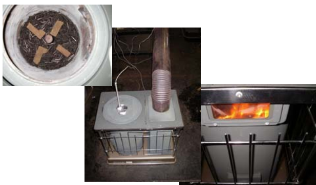
第1図 市販ストーブによる燃焼試験 （ホクダン（株）製サンストーブD2縦型）
