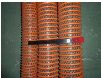
第 2 図 搬送システムのホース (左より、内径 φ50.8mm・φ63.5mm・φ76.2mm)
