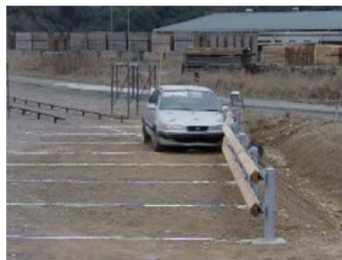
第 2 図 乗用車による衝突試験
