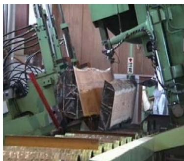
第 1 図 カラマツ大径材の製材
