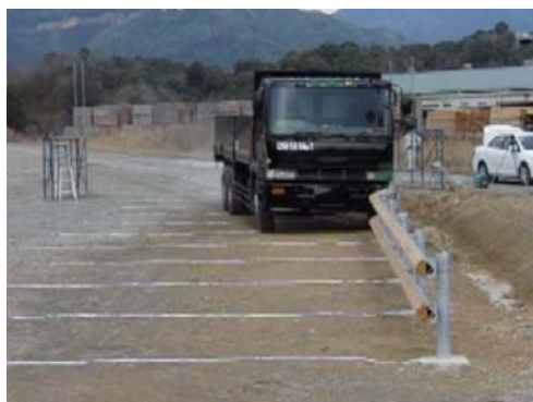
第 1 図 大型貨物車による衝突試験
