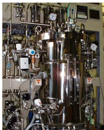
第 1 図 50L 発酵槽による並行複発酵試験
