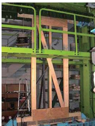
第 1 図 合板釘打ち補強方法
