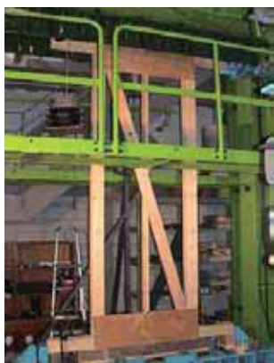
第 1 図 合板釘打ち補強方法
