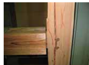
第 3 図 土台の割裂破壊
