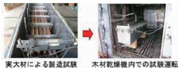
第1図 木材乾燥機を利用した実大材の製造試験
