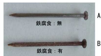
第 2 図 鉄腐食性試験
