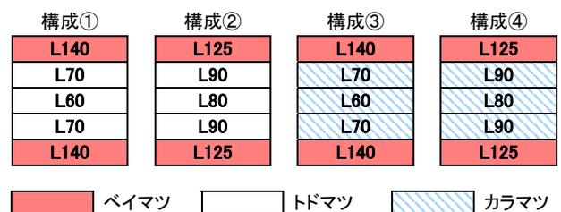
第 1 図 試験体の断面構成
