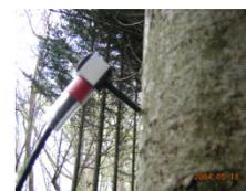
第 3 図 応力波伝播速度の測定
