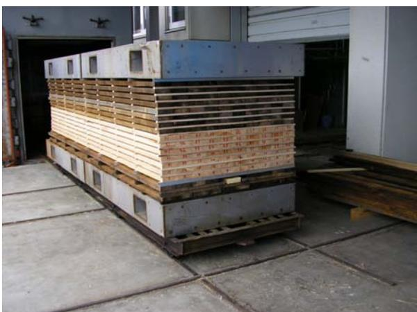
第 1 図 乾燥試験における栈積み
