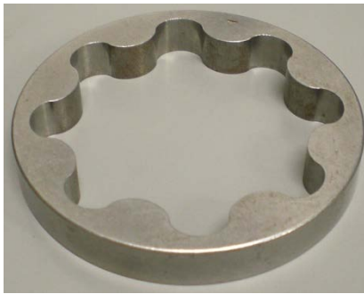
図-4 目標とした自動車部品（オイルポンプギア） （外径φ64mm、厚み9mm）
