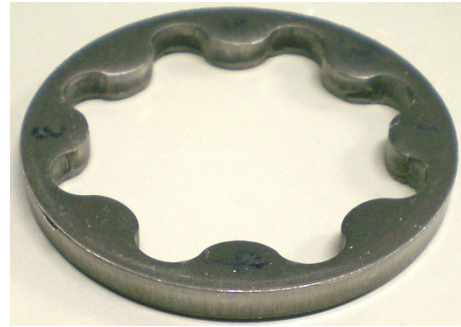
図-5 加工実験の結果 （外径φ64mm、厚み6mm）
