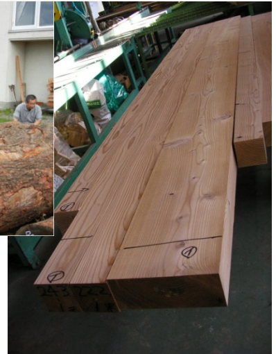
図-2 樹心から離して製材することで割れを防止
