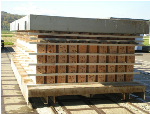
図-5 柱材の栈積例
