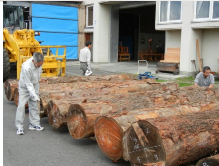
図-1 原木の強度による選別
