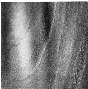
写真 7 刃先高さ +6\text{mm} 原木半径 7\text{cm} 取付角 +2^\circ
