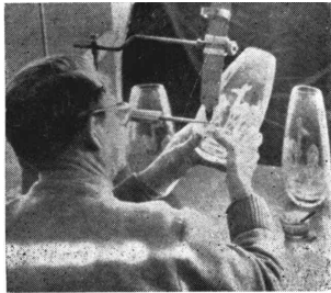
コスタ硝子工場にてカットガラス工作中 (8月号記事)
