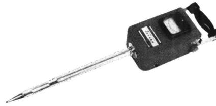
写真 2. 簡易型チップ検収計 (B型)
