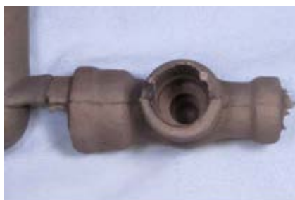
図-6 銅合金バルブ部品の試作事例(RP鋳型(左)と銅合金鋳物(右))
