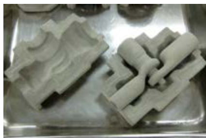
図-6 銅合金バルブ部品の試作事例(RP鋳型(左)と銅合金鋳物(右))
