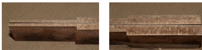
(上側は粉末RPによる鋳物試験片、 下側は生型による鋳物試験片)
