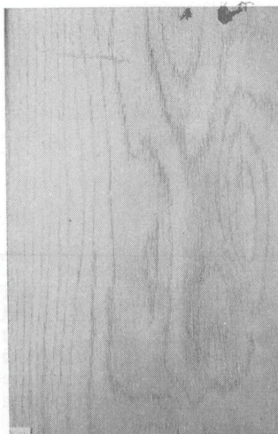
写真1 平滑なナラ単板 (厚さ2.0mm)
