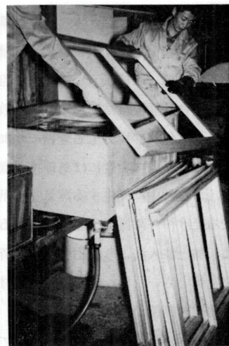
写真4. 浸漬法防腐処理状況
