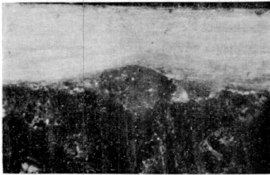
第11図 心板のジョイント不良（接着剤の流出）
