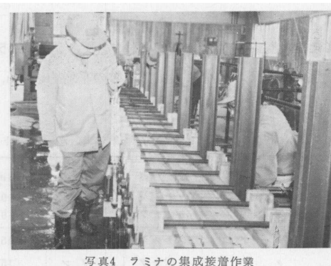
写真4 ラミナの集成接着作業
