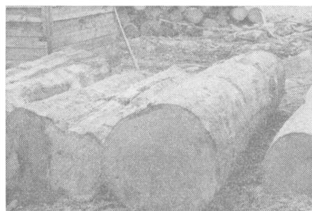
左：カッターヘッドの圧力が強い場合の材面
