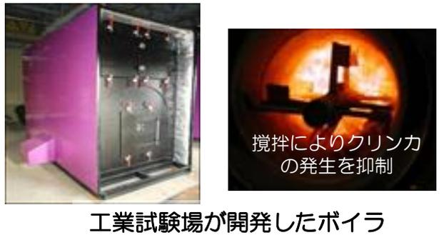
○開発したボイラで燃焼することにより、高灰分の燃料でもクリンカの発生を抑制。
