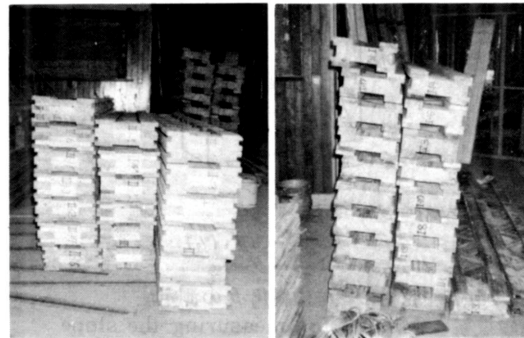
(a) TYPE-II, III (b) TYPE-I Fig.5 135日間の自然乾燥を終えた後の試験体の実況 Actual state of specimens after 135 day's seasoning.
