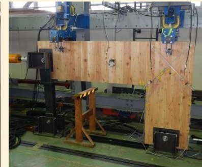
【開口パネル性能試験】
