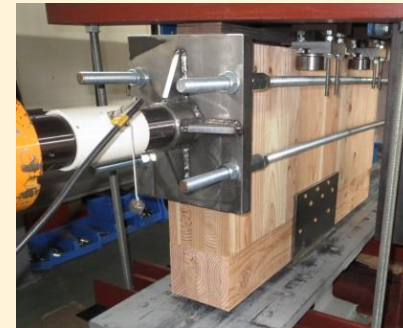
【接合性能試験】
