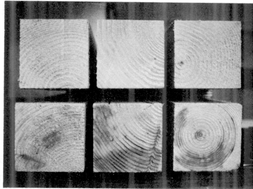
写真1 乾燥前の木口断面 上段：低含水率材、下段：水食いを含む高含水率材
