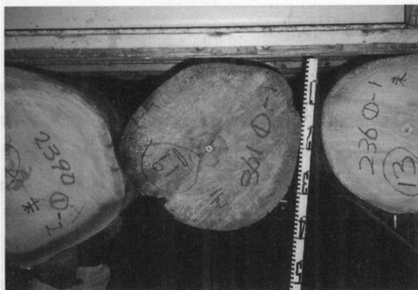
写真1-3 キャンプノスペルマ(造林木)の木口腐れ,変色
