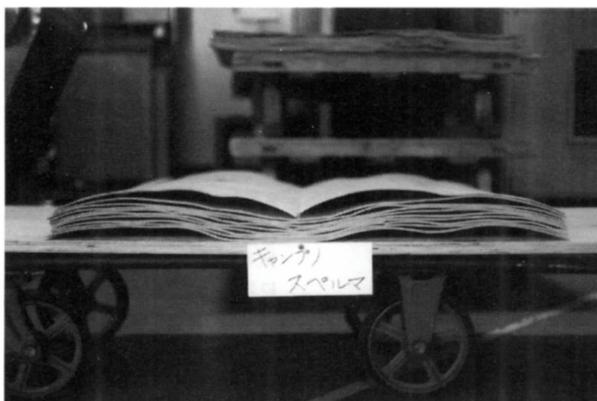
写真9-1 キャンプノスペルマの乾燥後の単板
