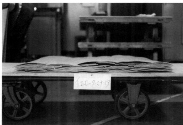
写真9-3 ターミナリアの乾燥後の単板
