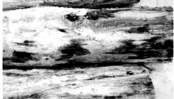
写真1 - 2 モルツカネムの材面の変色
