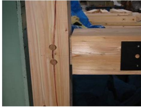
土台の割裂破壊
