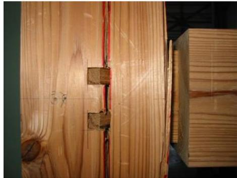
土台の割裂破壊
