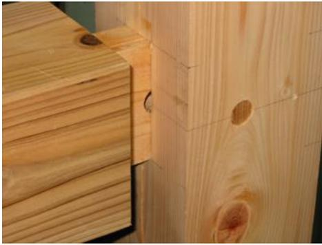
込栓の曲げ破壊
