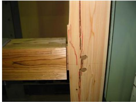
土台の割裂破壊
