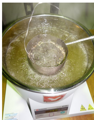
第1図 オイルバス(ヤマト科学株式会社製BO400型)による木質バイオマス燃料のフライ乾燥
