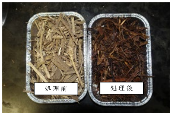
第2図 フライ乾燥後の材色変化(破碎チップ)
