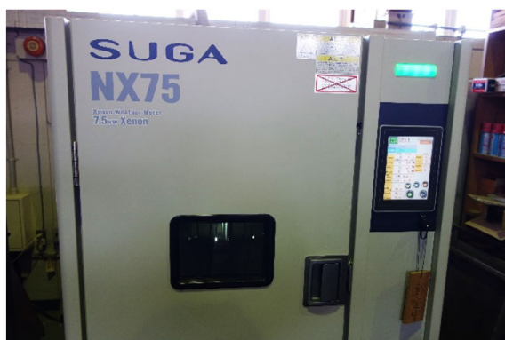
第4図 ウェザーメーターによる促進耐候性試験
