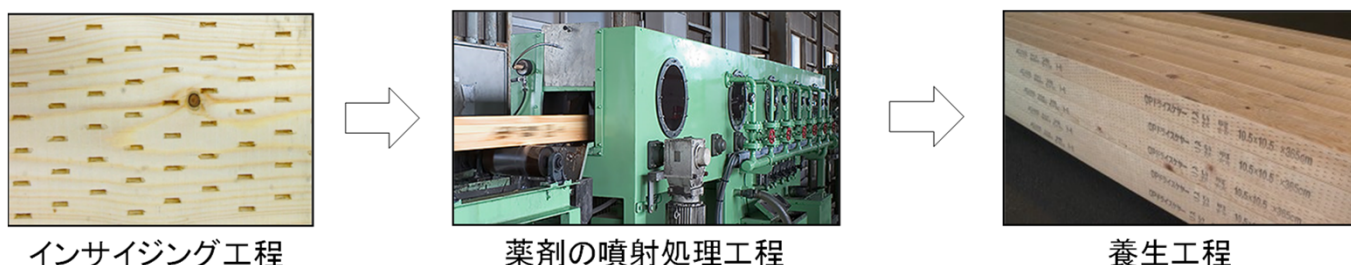
第1図 深浸潤処理の工程
