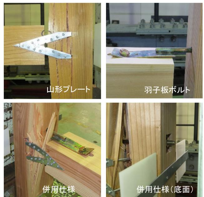
第3図 破壊性状
