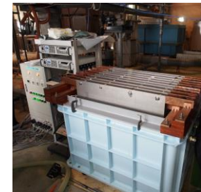
脱カドミウム実証試験用電解装置
