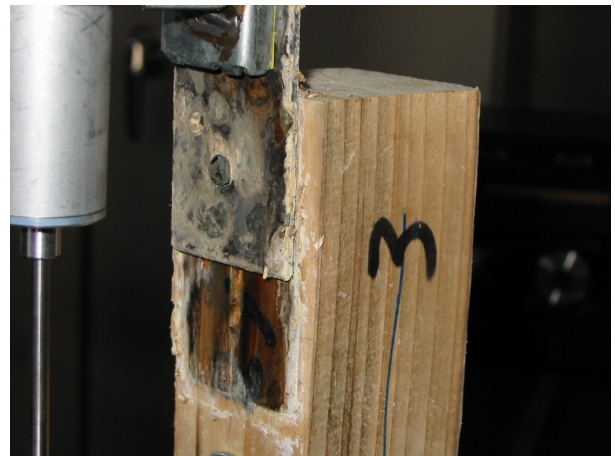
第1図 強制腐朽させた接合部モデルのせん断試験
