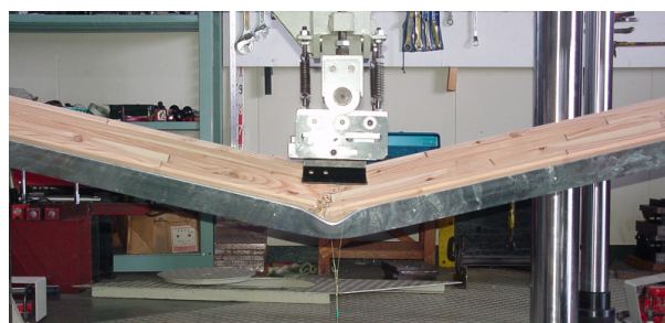
第2図 ハイブリッドビームの実大曲げ強度試験
