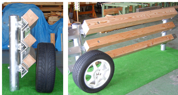
第1図 試作した木製ガードレール（B種相当）
