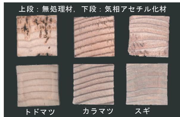
第1図 無処理材と気相アセチル化材のオオウズラタケによる腐朽状況の比較(木口断面での観察)
