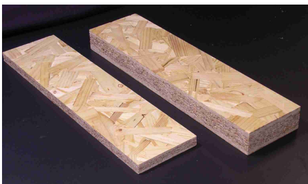
第1図 12mm厚標準品および 28mm厚床下地用トドマツSPB
