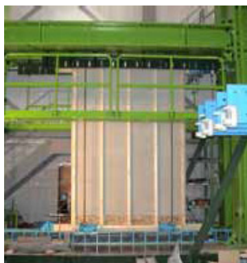
第 2 図 実大壁の面内せん断試験
