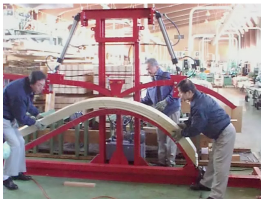
第1図 試作機によるわん曲集成材の製造
