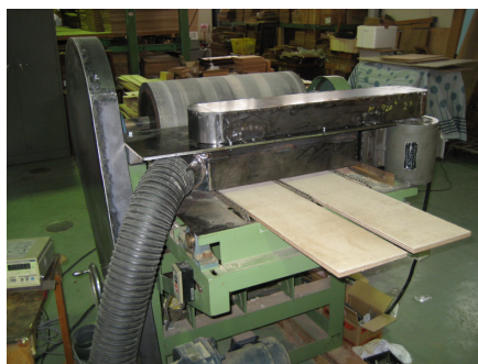
第 2 図 試作したブラッシング装置
