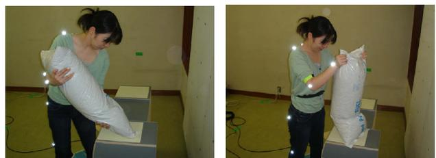
第 1 図 投入動作・傾け入れ (左) と吊るし入れ (右)
