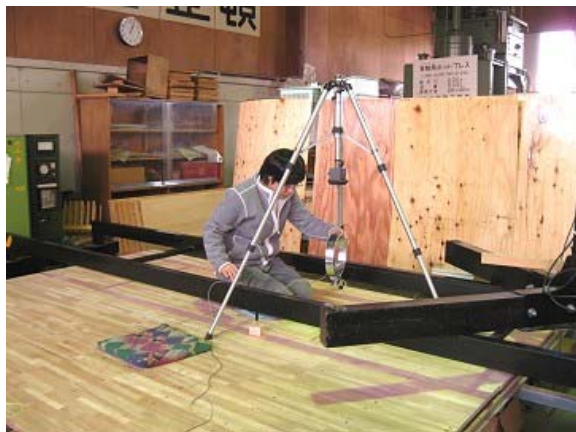
第 1 図 実大床における床性能測定
